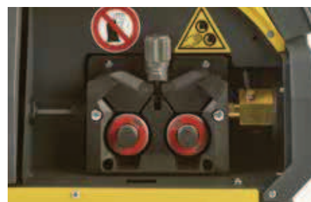
Profesionální podávací systém se 4 otočnými kladkami pro dva průměry drátu (0,8 a 1,0mm)
